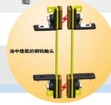
油中熄弧的铜钨触头
