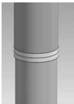
图 46 卡箍固定防护罩
