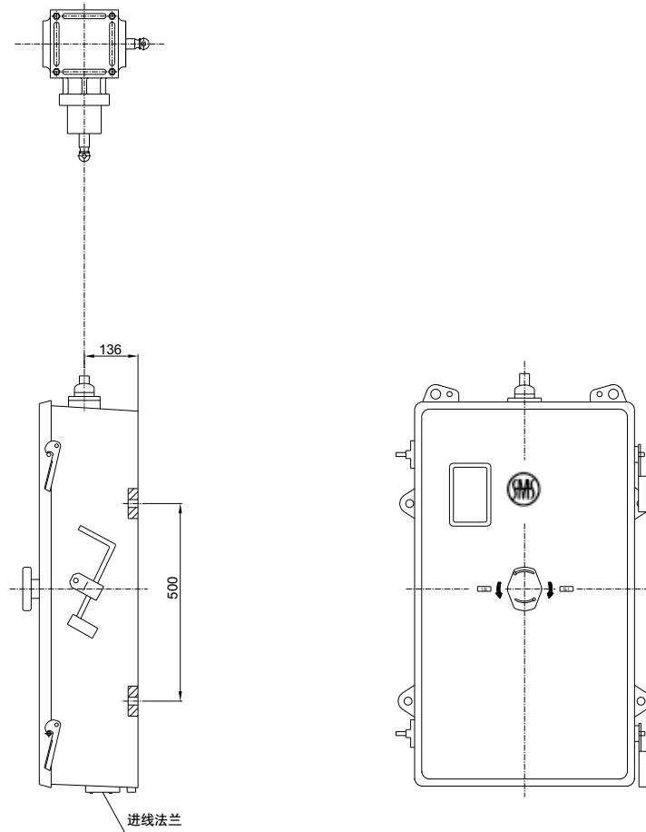
图6 CMA7电动机构的安装
