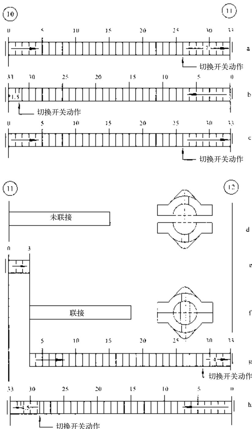
a,b 在两个方向切换开关动作后，记录指示轮格数
